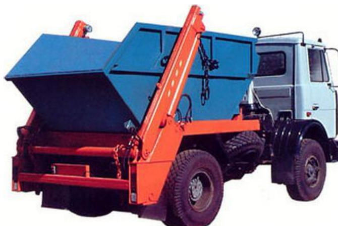
Рис. 9.3 - Бункеровоз МКС-3501 на шасси МАЗ-5551А2
