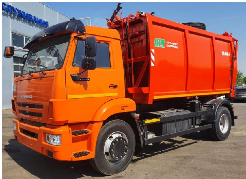
Рис. 9.2 - Мусоровоз с боковой загрузкой КО-427-90 на базе шасси КАМАЗ КО 440-7
