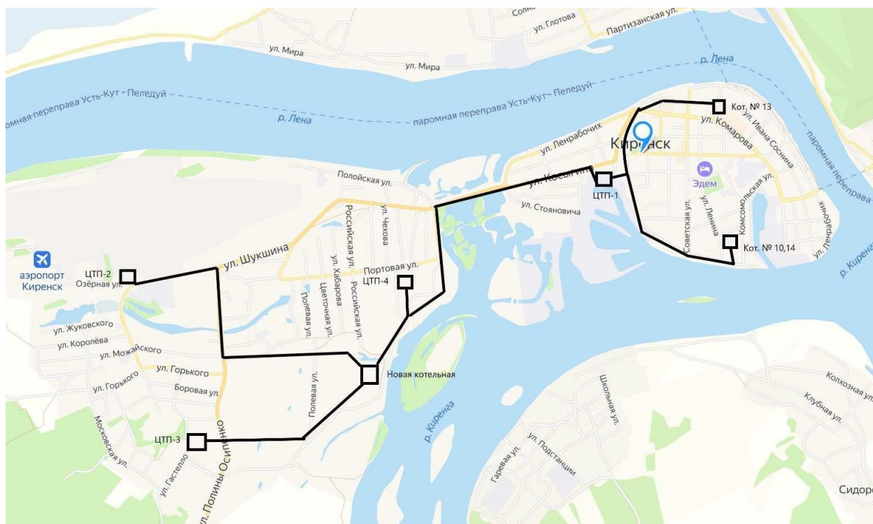
Рисунок 4.1.1 - Схема расположения новой котельной, ЦТП и тепловых сетей
